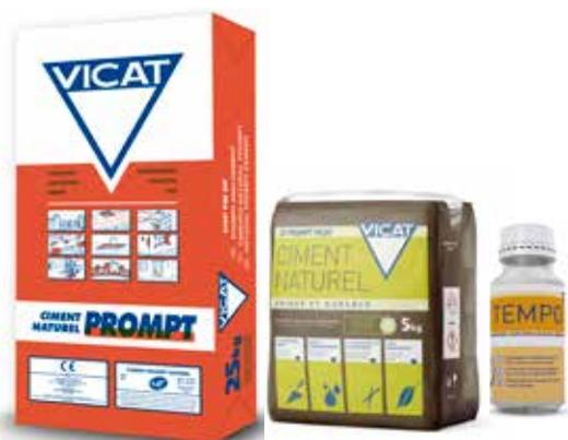
El cemento natural Prompt es un aglomerante hidráulico perteneciente al grupo de las cales hidráulicas (HL). Resulta de la cocción de una única piedra caliza, entre 800 y 1200 °C, en horno vertical, seguida de una molienda muy fina (> a 7.000 Blaine) sin aditivos de ningún tipo. Se fabrica desde 1842, sin cambios en sus propiedades, y tiene aplicaciones en múltiples campos de la construcción.
